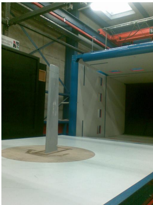
Špička listu rotora v aerodynamickom veternom tuneli – Kudelas, 2010
