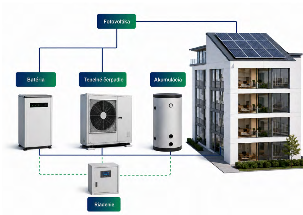
Obrázok 7.2: Koordinácia fotovoltiky, tepelného čerpadla a akumulácie energie v lokálnom zdrojovom systéme.
