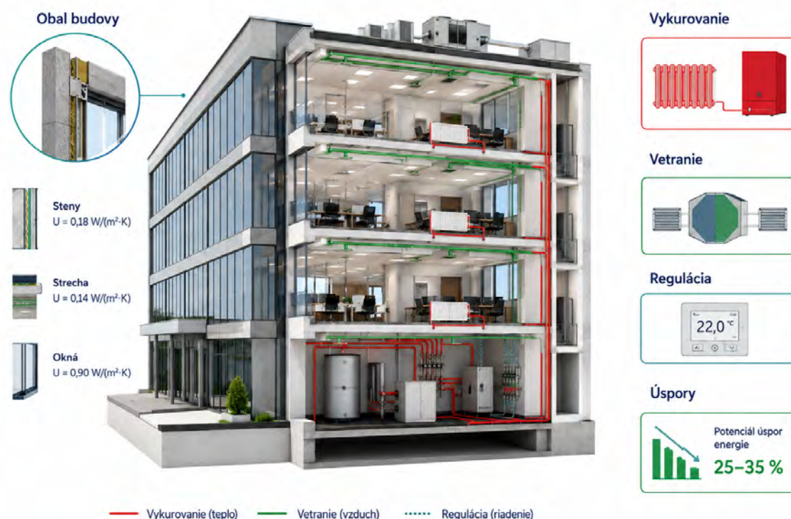
Obrázok 6.4: Analýza súčasného stavu objektu a identifikácia potenciálu úspor energie.
